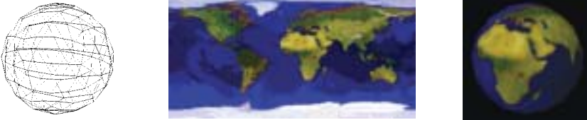
Abbildung 8.6: Für die interaktive Computergraphik wird die Geometrie einer Weltkugel als Dreiecksnetz ihrer Oberfläche repräsentiert. Für eine realistischere Darstellung wird ein Bild als Textur auf die Oberfläche aufgebracht. Dazu wird jedem Vertex der Geometrie eine Texturkoordinate im Bild zugewiesen und für jedes Fragment am Bildschirm die Farbe durch Interpolation berechnet.
