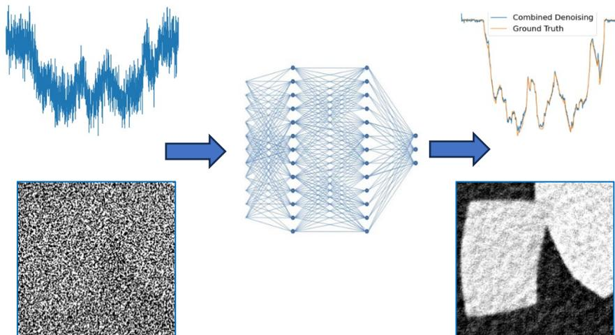
Die stark verrauschten CT-Rohdaten auf der linken Seite des obigen Bildes (Kurve in Blau) führen unten auf der linken Seite zu dem verrauschten 2D-Bild nach der CT-Rekonstruktion, in dem die Kontur des Objekts nur zu erahnen ist. Nach Anwendung des neuronalen Netzes in der Bildmitte werden die Projektionsdaten so stark entrauscht (rechte Seite oben), dass nach der CT-Rekonstruktion die Strukturen in dem entsprechende Bild (rechte Seite unten) sehr gut zu erkennen sind.
