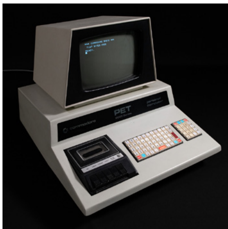
PET 2001, der erste all-in-one-Computer Tastatur, Bildschirm, Massenspeicher: alles für 2.000,- D-Mark
