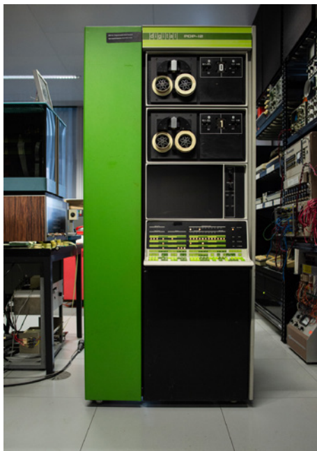
PDP-12, ein Zwitter, bestehend aus PDP-8 und LINC.
